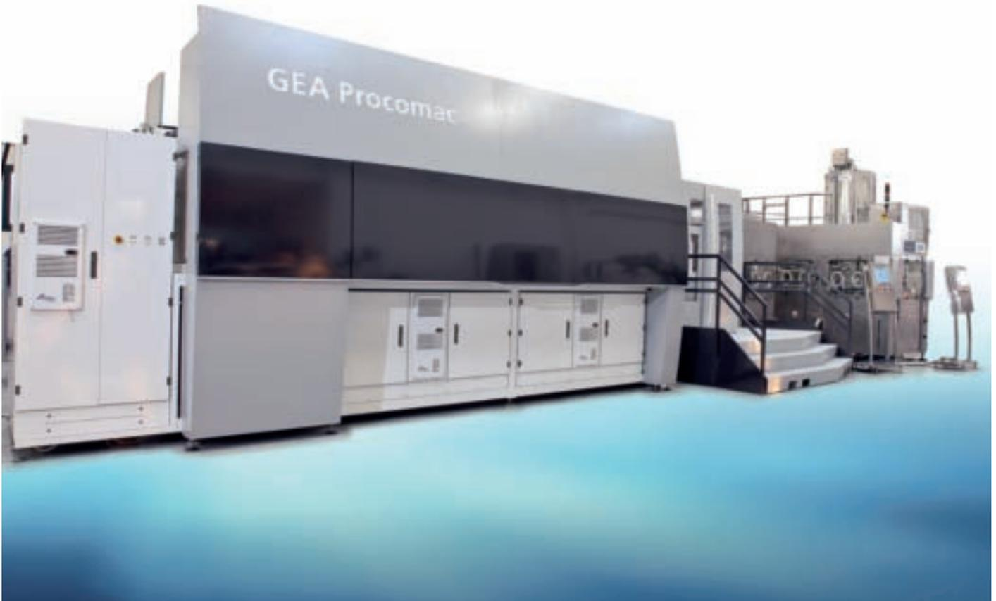
*Rendere sterile e sanificabile l'ambiente di una soffiatrice significa soprattutto isolare i cinematismi e le parti da lubrificare. La soluzione più semplice è collocarli al di sotto della macchina, ma il soffiaggio avverrà a preforma capovolta.*
