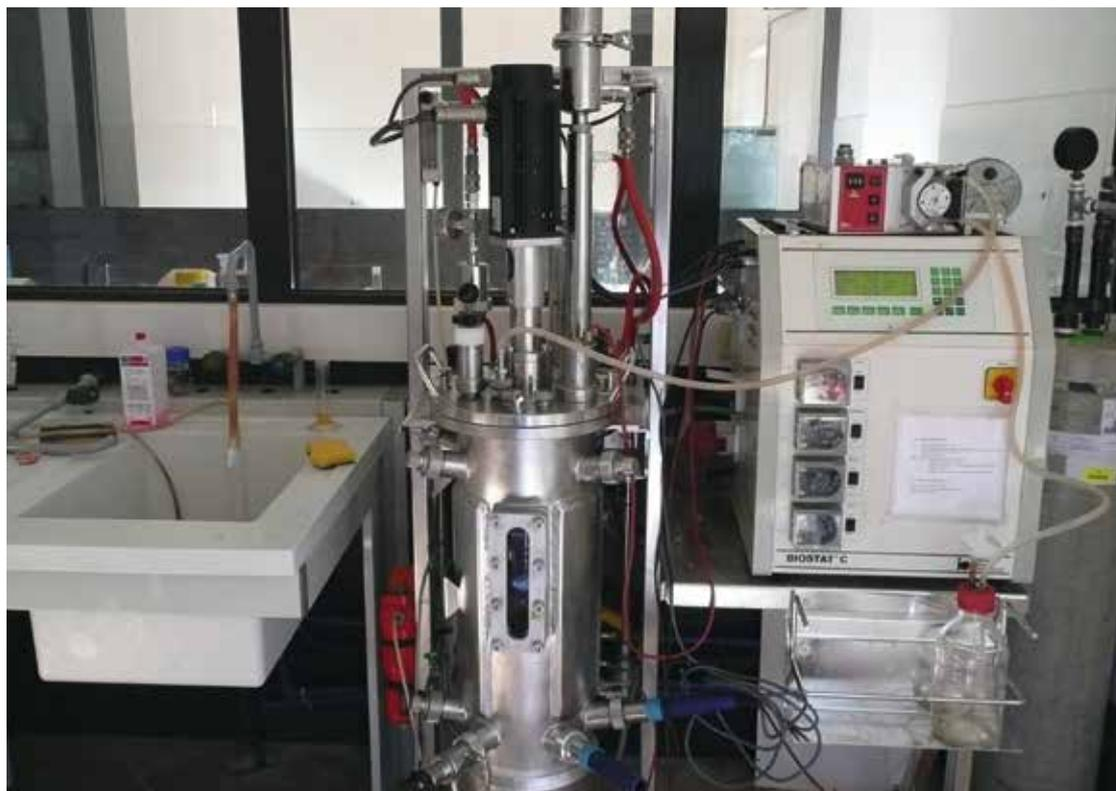
*Il fermentatore, l'apparecchio in cui avviene la crescita microbica.*
