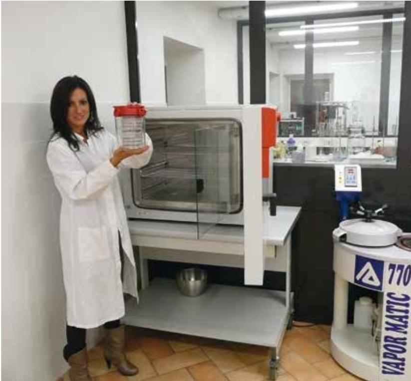
*Giulia Cinti, in laboratorio, controlla la crescita microbica in piastra. Le attrezzature visibili sono stufa e autoclave.*
