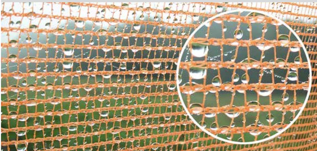
*La rete in poliestere, la prima superficie flessibile del sistema Warka Water, cattura il vapore acqueo; può essere realizzata anche con polimeri di riciclo.*
