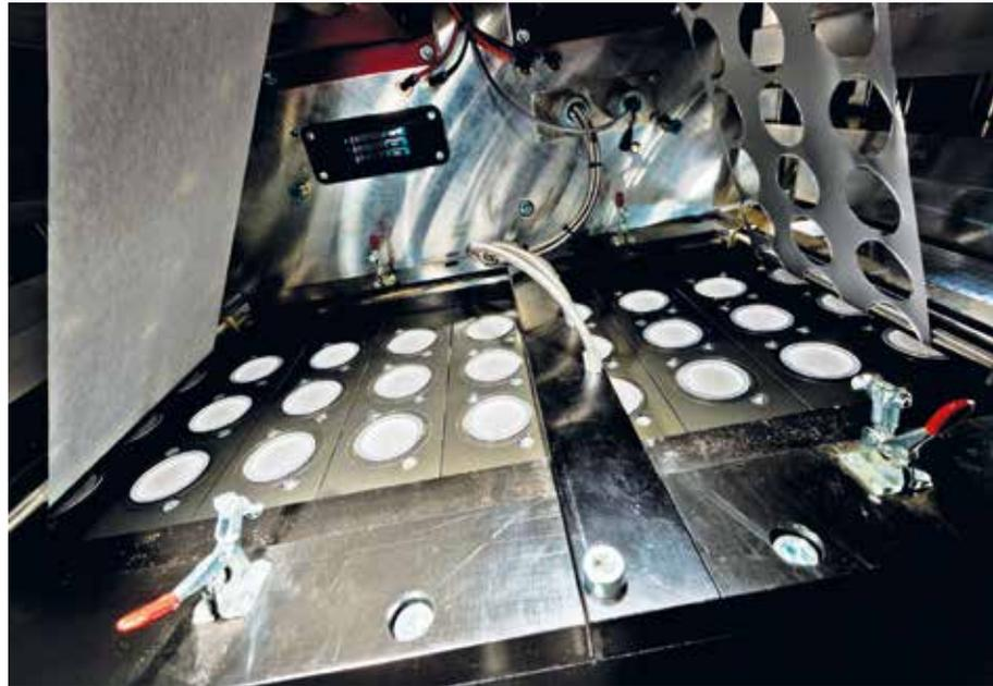
dipendentemente tempi di saldatura e velocità; tutti gli impianti possono lavorare in atmosfera modificata con residuo di ossigeno sotto 1%, anche per i prodotti solubili.
