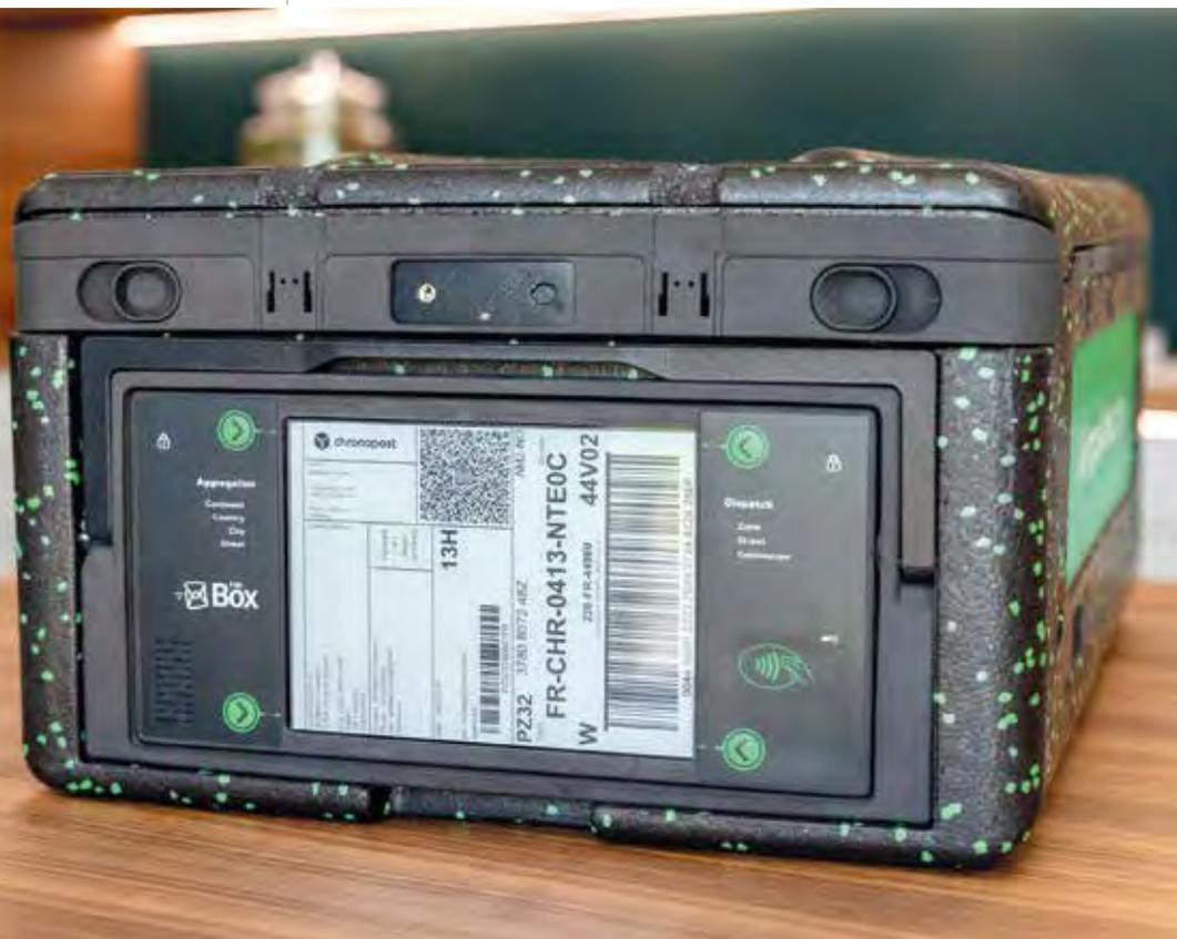
sori che, oltre a verificare gli stadi della spedizione e agevolare la restituzione, permettono di controllare temperatura, GPS, l'origine di eventuali urti e danni e altri parametri come umidità e pressione all'interno dell'imballo. A seconda del prodotto da spedire, The Box permette quindi alle aziende di monitorare, attraverso un'app, le variabili più importanti per la sua integrità e conservazione.
