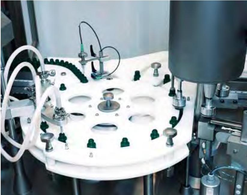
visibilità di ogni singola fase del ciclo, dal riempimento fino alla tappatura del flacone. Grazie alla sua versatilità, la ML 642 è una soluzione ideale per liquidi sia di tipo cosmetico sia di tipo farmaceutico, per cui può essere impostata sotto flusso laminare.
