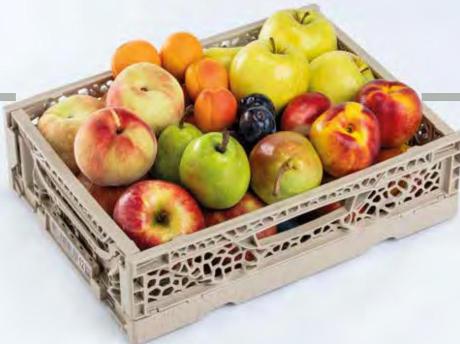
La resistenza della cassa è stata ottenuta con elementi a bassorilievo e non con elementi pieni, producendo un alleggerimento del peso compreso fra il 6% e il 9%. Inoltre, lo spessore della base è diminuito da 35 a 30 millimetri e ciò permette di risparmiare spazio a terra, sui vettori e carburante, caricando su un posto pallet 288 cassette anziché 240, pari ad un +20% a cassette chiuse e dall'11% al 25% in più con le cassette aperte cariche di prodotto.
