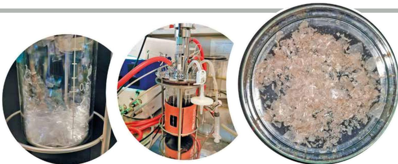
**Figura 2** – Idrolisi enzimatica di film in PLA dopo 7 giorni in incubazione a 37°C in un bioreattore di 1 L
