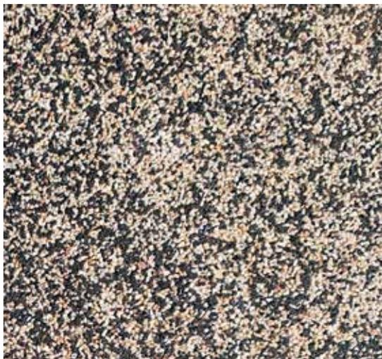
Il TULEG® FLEX presenta caratteristiche di stampabilità e modellabilità che derivano dalla presenza nel granulo di tutolo di granulo di gomma SBR e di resine poliuretaniche MDI aromatiche senza solventi
