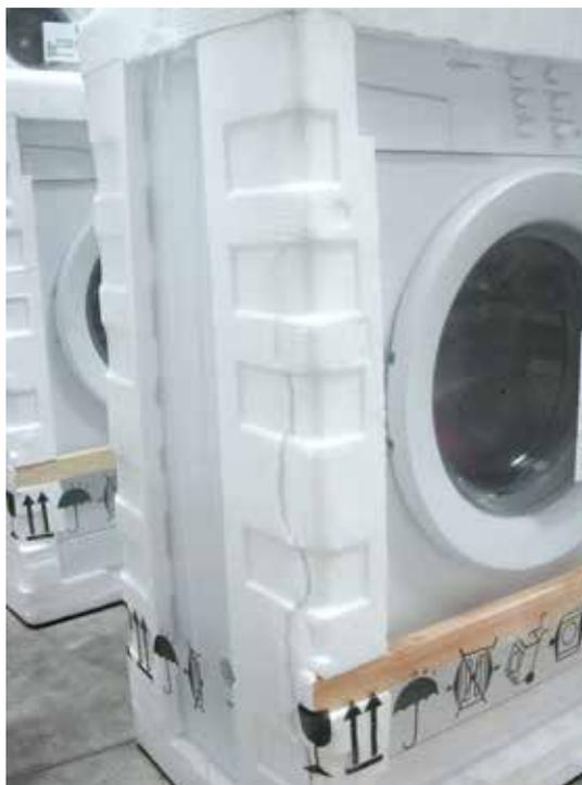
*Esempio di imballaggio che non ha resistito alle operazioni di movimentazione.*
