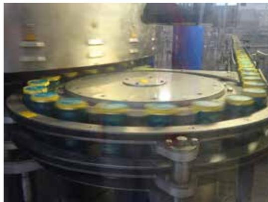
A sinistra, l'area dei 4 caricatori a fianco della giostra di termosaldatura. A destra, l'uscita dalla giostra di applicazione. At left, the area of the four loaders next to the heat-sealing conveyor; at right, exiting from the application conveyor.
