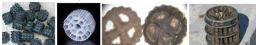
FIG. 2 – Tipologie di carrier utilizzati nella tecnologia MBBR. Nelle ultime 2 è facilmente visibile il fango adesivo.
