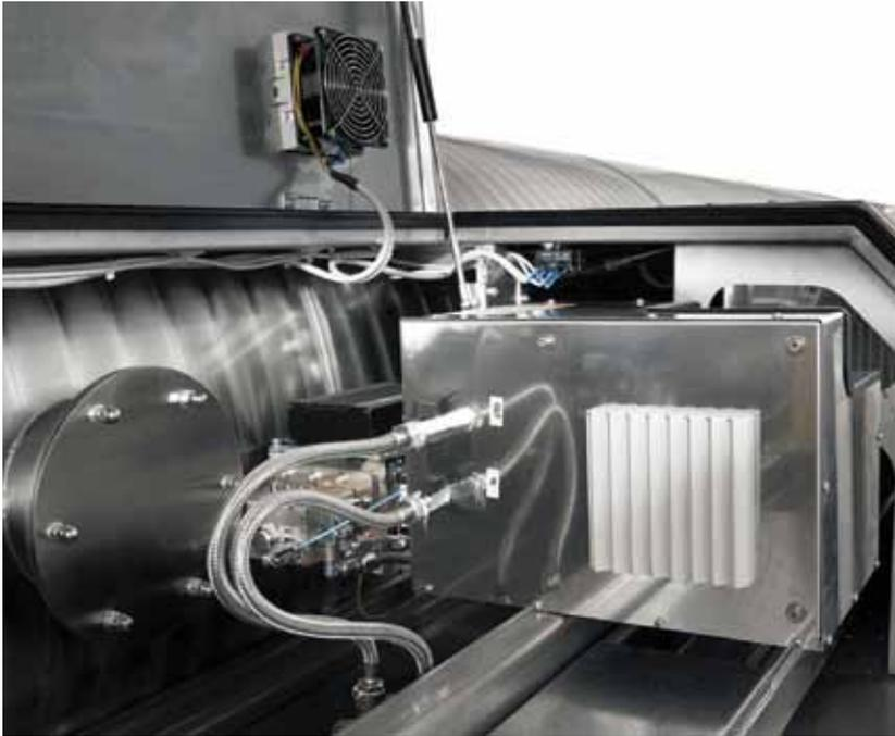
*L'impianto è dotato di 6 generatori di microonde connessi direttamente alla camera di trattamento.*
