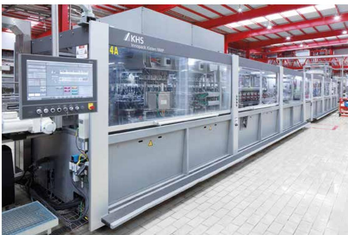
La marca spagnola apprezza particolarmente "l'alto livello di innovazione" del suo fornitore tedesco, soprattutto nel fine linea. Uno dei progetti più recenti riguarda una linea di riempimento lattine con una capacità di 72.000 contenitori all'ora. L'installazione comprende due fardellatrici ad 'alto contenuto ambientale'.
