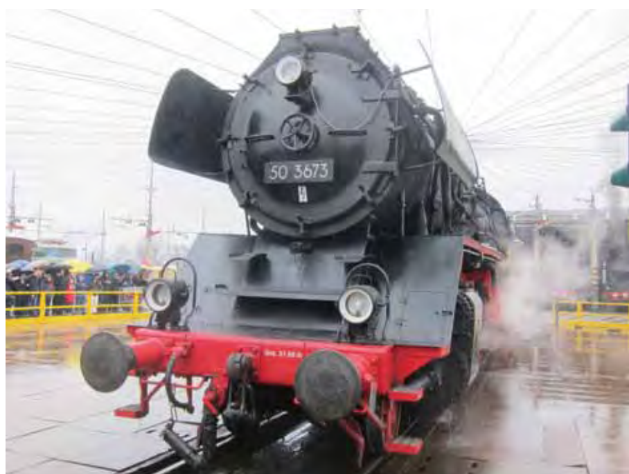
Locomotiva a vapore tedesca del gruppo 50, utilizzata per treni merci fino agli anni '80 nella DDR.
