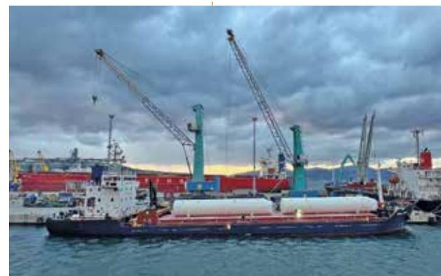
*Trasporto fuori scala realizzato da MVN dalla Turchia all'Italia, in modalità Break Bulk, di due LNG Storage Tanks: 24 metri di lunghezza per 55 t ciascuno.*
