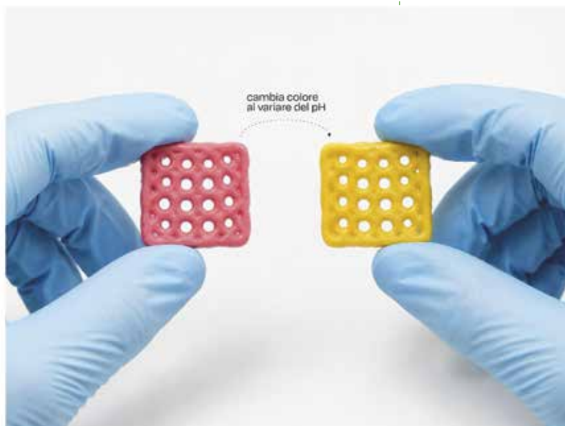
Figura 4 - POTENZIALE INDICATORE DI pH STAMPATO CON TECNOLOGIA 4D
