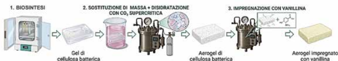
Figura 2 Schema del processo produttivo di aerogel di cellulosa batterica impregnati con vanillina.
