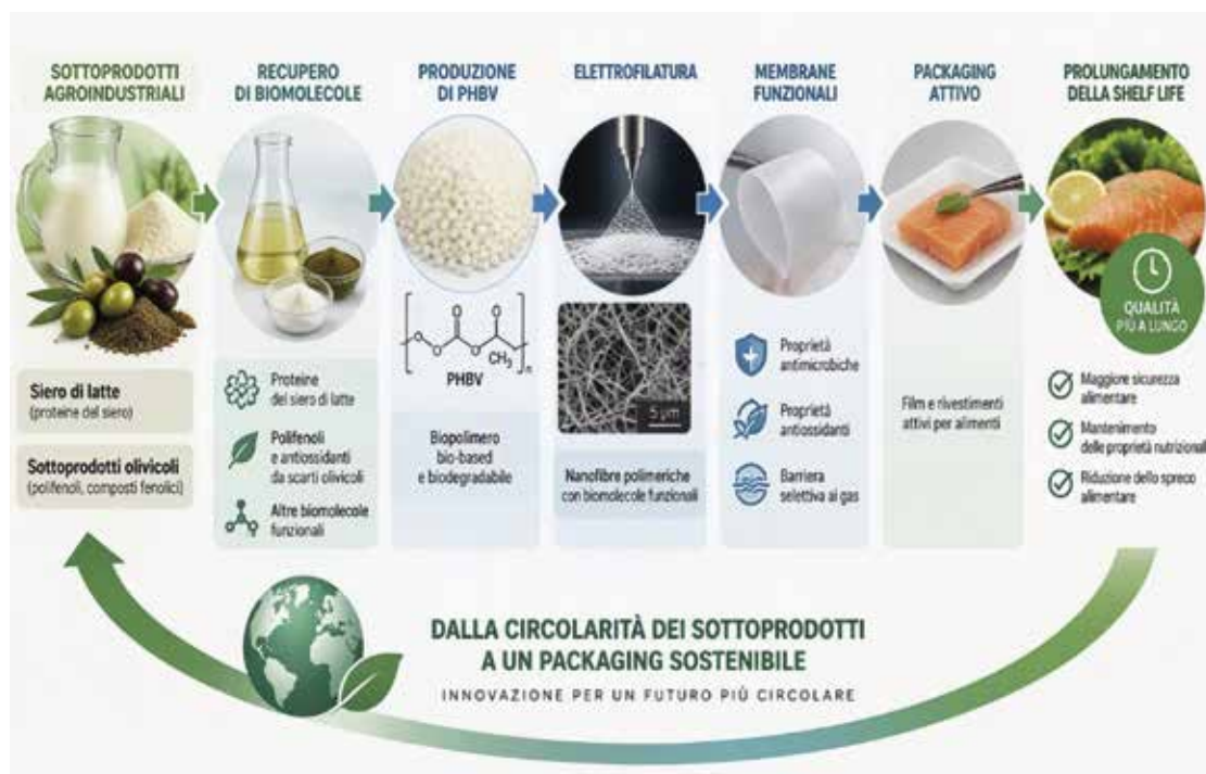
Figura 1 Approccio circolare per lo sviluppo di materiali innovativi destinati al packaging alimentare: dai sottoprodotti agroindustriali al recupero di biomolecole funzionali, fino alla produzione di membrane in PHBV mediante elettrofilatura per applicazioni di packaging attivo e prolungamento della shelf-life (elaborazione degli autori).
